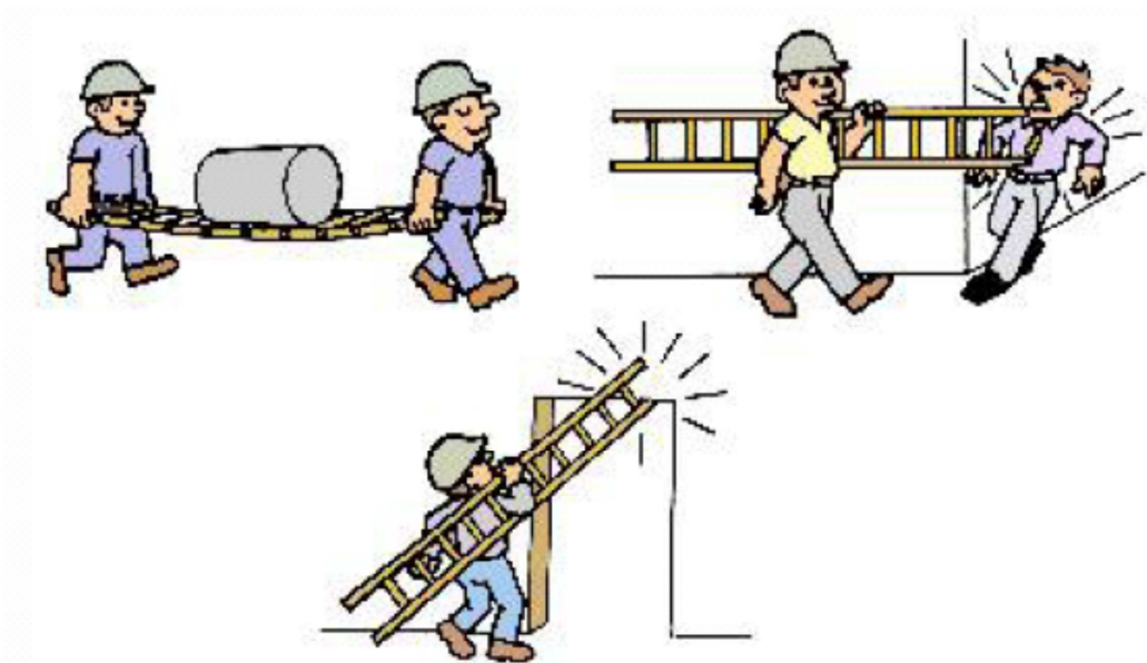
Figura 1. Formes incorrectes de transportar les escales
